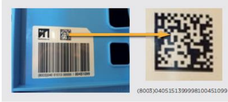
Şekil 4 - GS1 DataMatrix'te kodlanmış bir GRAI içeren bir et kutusu örneği
